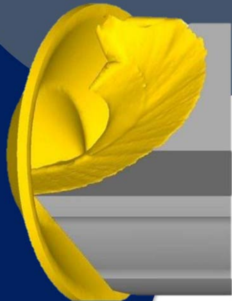
Modellierung der Spannbildung mit FEM, Bild: IfW
