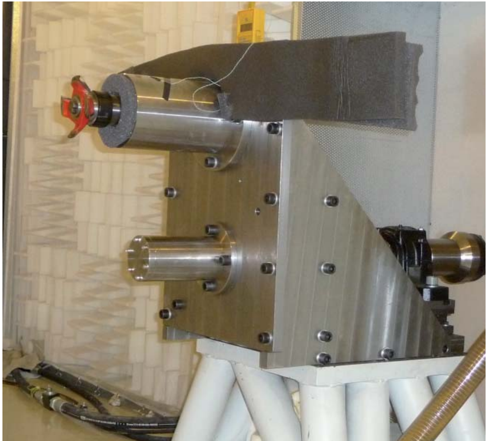
Bild 2: Rotationsprüfstand für die Untersuchung von strömungs-akustischen Eigenschaften von massiven Werkzeugen
